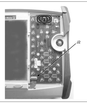
Figure 19. Keypad PCB
